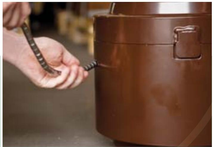
Einfache Montage der Scherelemente
